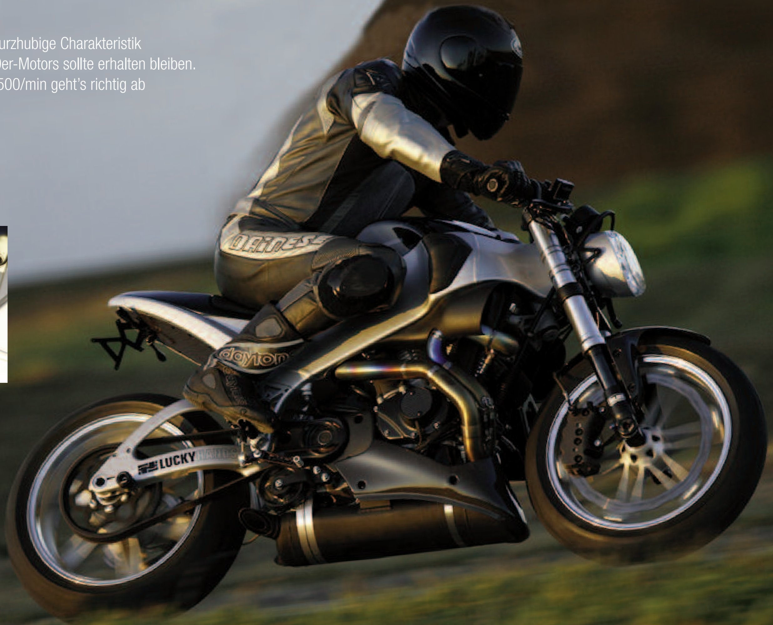
Die Leichtmetall-Hinterradschwinge hält ein fein ansprechendes Ölins-Federbein im Zaum
