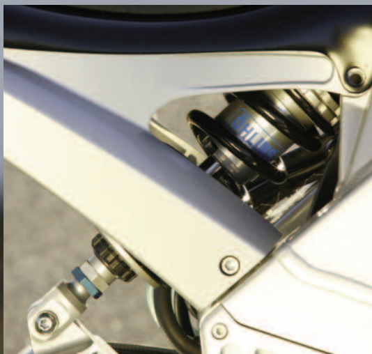
Die Leichtmetall-Hinterradschwinge hält ein fein ansprechendes Ölins-Federbein im Zaum
