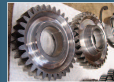
Einige Getriebezahnräder ausgedreht, Wellen aufgebohrt. Spart rund drei Kilo
