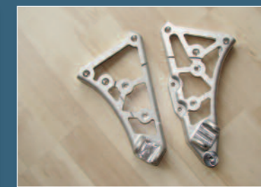
Originale, aber ausgefräbte Fußrasten. Spart 178 Gramm
