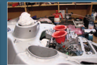
Erste Versuche noch mit Keihin-Vergasern. Die passten aber nicht
