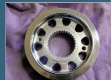
Klassisches Buell-Tuning: stark erleichtertes vorderes Riemenrad
