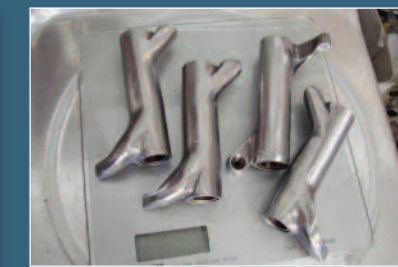
Kipphebel auf das gleiche Gewicht gebracht. Alle um die 250 Gramm
