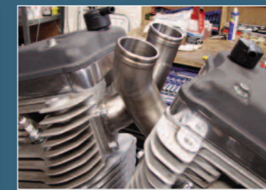
Die Lösung: umgeschweißte Köpfe und separate Ansaugrohre für die Vergaser
