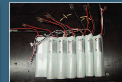
LiFePo4. Wiegen 1960 Gramm und haben 16,1 Ah. Original: 12 Ah und 5300 Gramm
