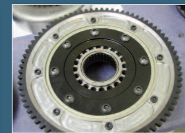
Alu-Kupplungskorb mit ausgedrehtem Starterkranz und eingefräbten Taschen
